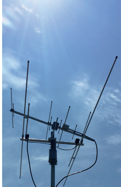
Figuur 2. De 2 meter en 6 meter band-antennes.
